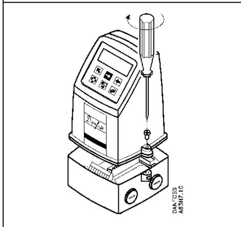
Установить преобразователь сигналов на клеммную коробку.
