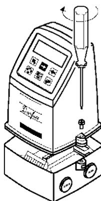
Установить преобразователь сигнала на клеммную коробку.
