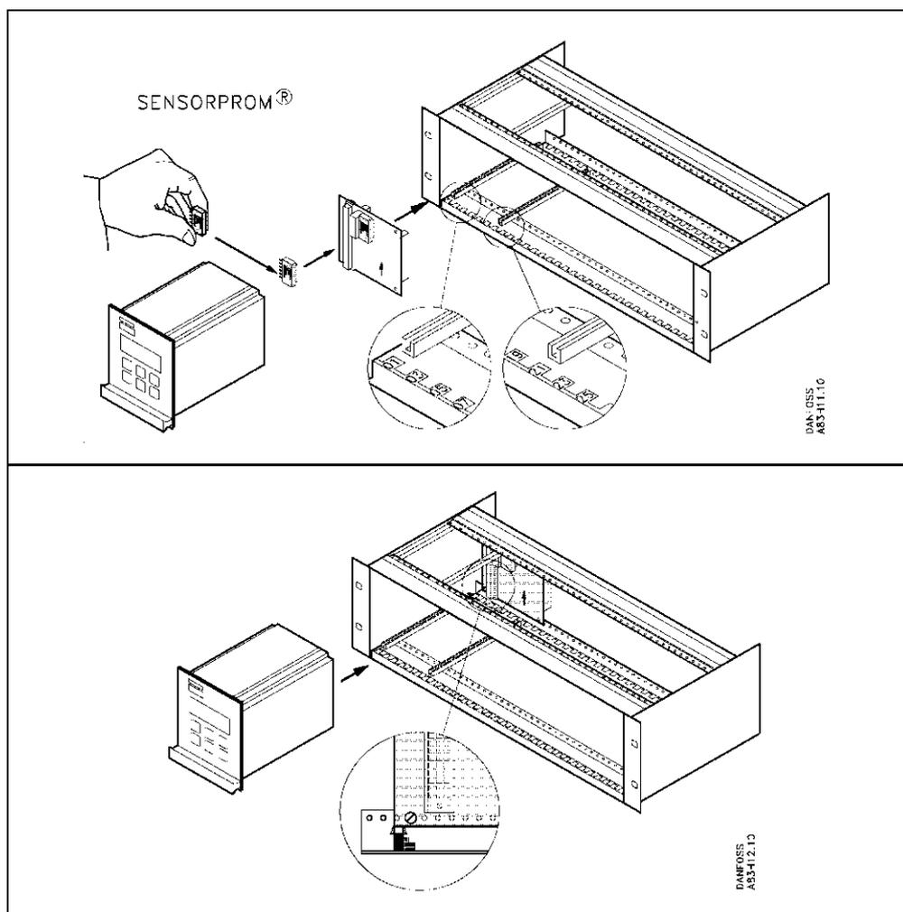
1. Закрепить блок памяти SENSORPROM ® на соединительной плате, поставляемой вместе с преобразователем сигналов. Блок памяти SENSORPROM ® поставляется с датчиком .
