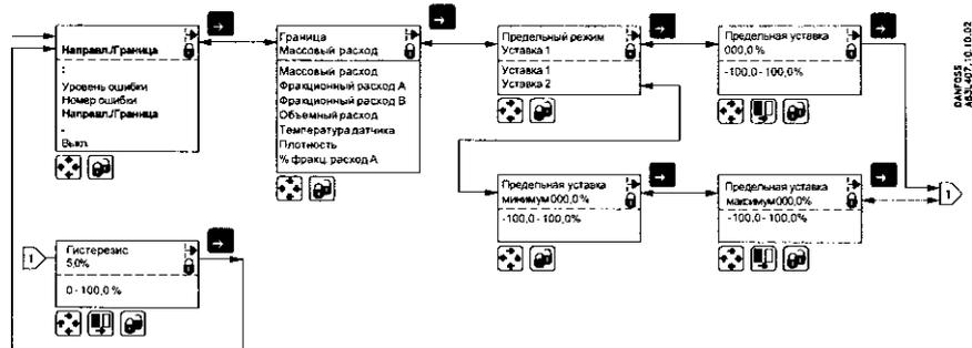
**Направление потока:** выбрать уставку 1 при нулевом расходе; гистерезис при 5%.
