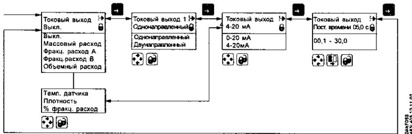
Если токовый выход не используется, то он должен быть установлен на ВЫКЛ.
