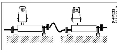
Взаимное влияние датчиков, расположенных близко друг к другу, может внести ошибки в измерения. Для предотвращения взаимного влияния не следует устанавливать датчики на расстоянии меньше одного метра относительно друг друга на едином фундаменте, а между датчиками устанавливать гибкий трубопровод, как это показано на рисунке.
