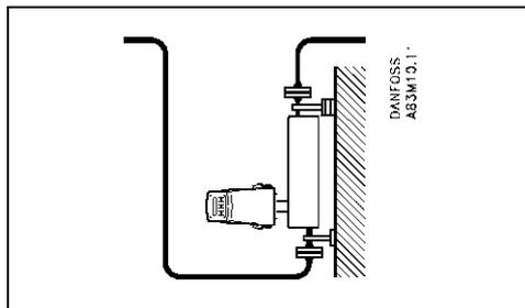
Размещайте датчик в нижней части системы, чтобы избежать пониженного давления в датчике, которое может привести к сепарации воздуха или газа в жидкости.
