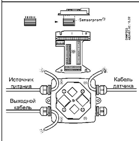
Вынуть блок памяти SENSORPROM® из датчика. Установить блок SENSORPROM® в настенном монтажном блоке, как это показано на рисунке.
