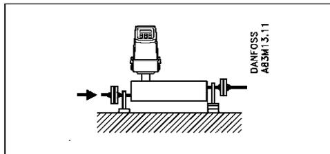
Датчик должен быть установлен на фундаменте или капитальной стене с отсутствием вибраций, как это показано на рисунке.
