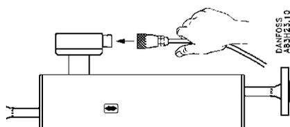
Установить пробки в переходнике и затянуть вводы на пробках для получения надежного уплотнения.
