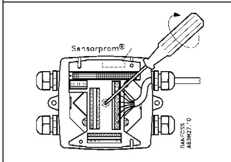
Установить соединительную плату в клеммной коробке. Тщательно затянуть заземляющий винт в центре клеммной коробки.
