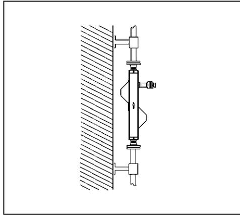
Датчик должен крепиться к трубопроводу, ответные части (фланцы) которого жестко закреплены на двух опорах.
