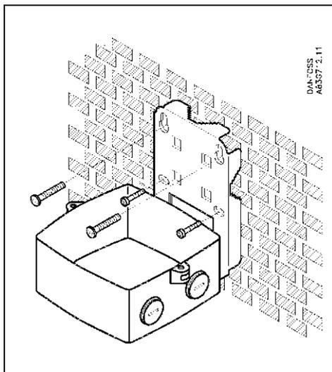
Установить кронштейн на стене, на трубе или на задней стороне панели.
