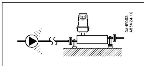
Размещайте расходомер как можно дальше от оборудования, генерирующего механические вибрации в трубопроводе.
