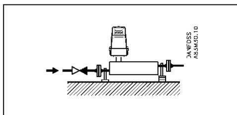
Для облегчения настройки нулевой точки в соединении с датчиком должен быть установлен клапан, обеспечивающий надежное отключение, поскольку для получения высокой точности необходима соответствующая установка нулевой точки.
