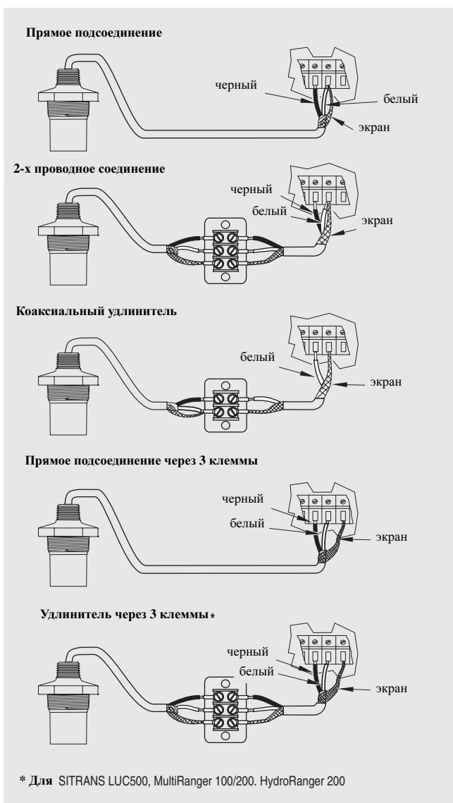
ST-H ультразвуковой сенсор, схема соединения
