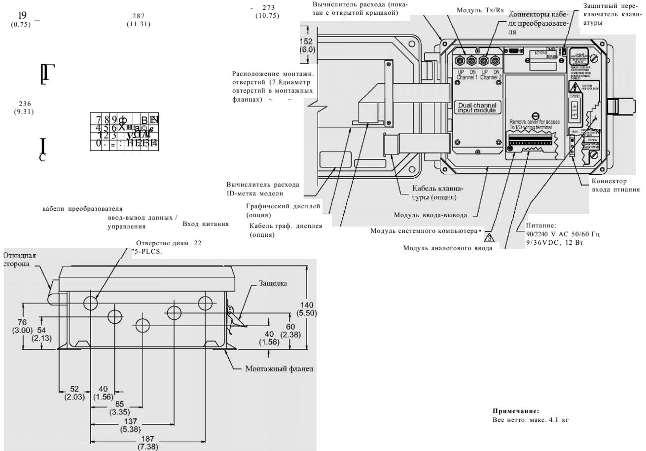
*FUS1010, FUH1010 и FUG1010 Компактный взрывонепроницаемый корпус IP65 (NEMA 7)*
