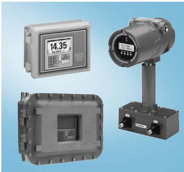
SITRANS FUS1010 - это наиболее гибкий из существующих на сегодняшний день ультразвуковых расходомеров clamp-on. Он может работать по любому из принципов - времени перехода Wide-Beam или режиме отражения (доплеровском), что делает его пригодным практически для любой жидкости, даже с высоким содержанием газов или взвесей твердых веществ.
