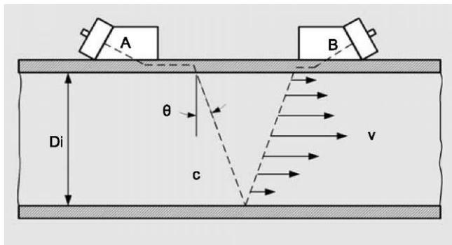
Преобразователь с подключением clamp-on, смонтированный в конфигурации с отражением
