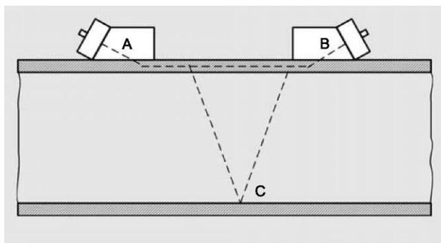
Этот второй путь дает измерительному прибору опорный сигнал, который полностью независим от величины расхода, и поэтому может использоваться как мера "расхолаживания" преобразователя. Путем непрерывного анализа этого сигнала стенки трубы расходомер FUS1010 может динамически корректировать ошибки в расходе, вызванные дрейфом нуля.
