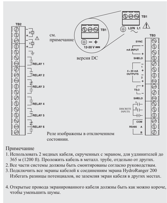
HydroRanger 200, схема соединения
