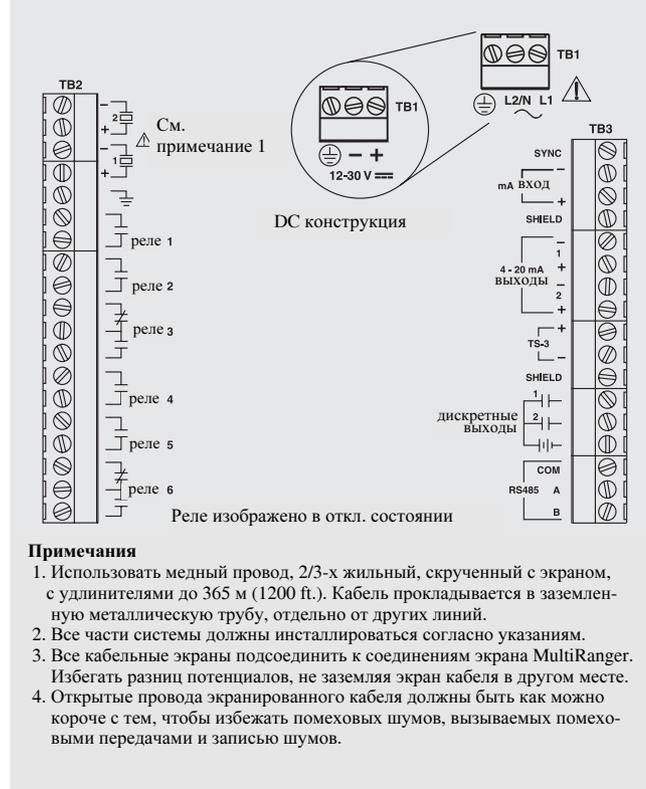
MultiRanger, схема соединения
