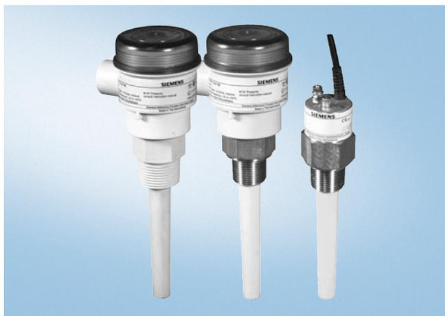
Pointek CLS 100 - это компактный, емкостный 2-х проводный сигнализатор для регистрации уровня в установках с ограничением места, для разделительных слоев, сыпучих веществ, жидкостей, взвесей и пены.
