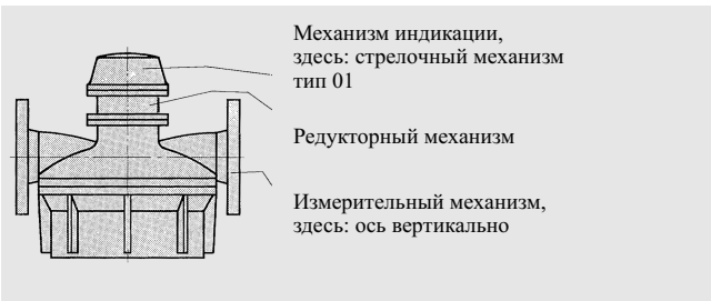
Рис. 3/151 Кольцевой счетчик DN 50 (2") без доп. модулей
