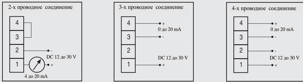
Рис 3/89 Сельсин-измерительный преобразователь SITRANS FVA 252, схемы соединения
