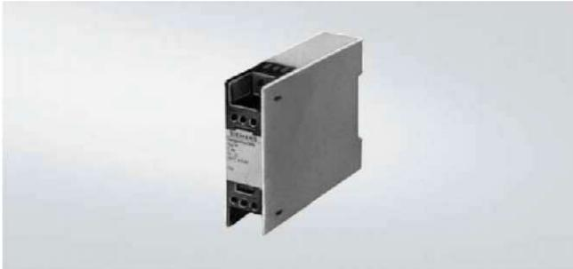
Клемма термокомпенсации подходит для сенсора типа J, K, L, R, S, T или U. Встроенная схема коррекции компенсирует влияние изменений температур клемм термокомпенсации. Прибор может быть смонтирован на несущую шину. Внимание: расположение клеммы термокомпенсации вблизи от места измерения позволяет сэкономить на дорогой компенсационной линии.
