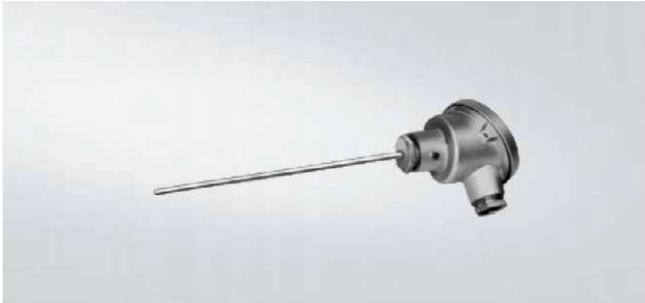
Термопара в оболочке с соединительной головкой, форма В подходит для диапазона температур от 0 до 800 или 1100 °С, может поставляться также со встроенным измерительным преобразователем температуры.
